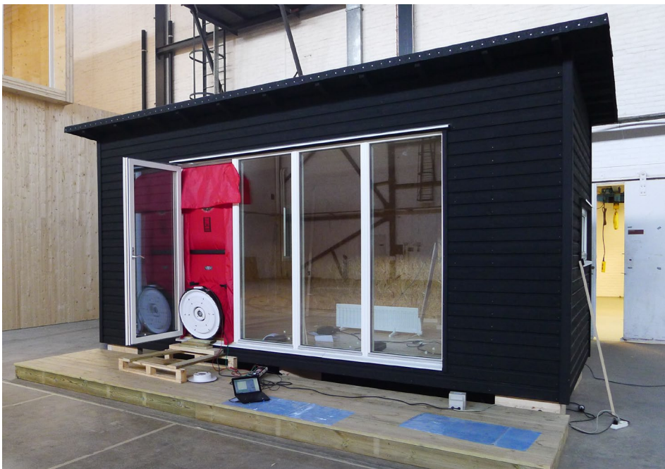
Figur 18. Gäststuga med monterad Blower door.
